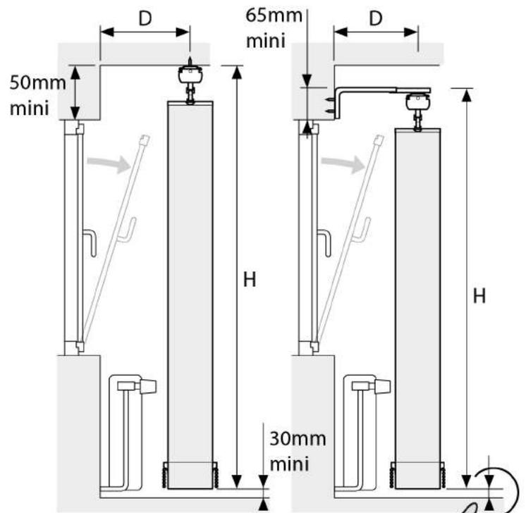
Calculez la distance (D) en fonction des éléments existants afin d'assurer le bon fonctionnement du store et de la fenêtre.
