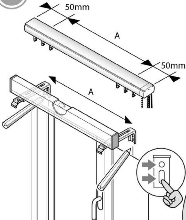
Implantez la position des équerres sur le mur en respectant le niveau et l'aplomb.
